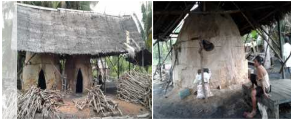
Gambar 6. Tungku arang organik yang hemat energi
