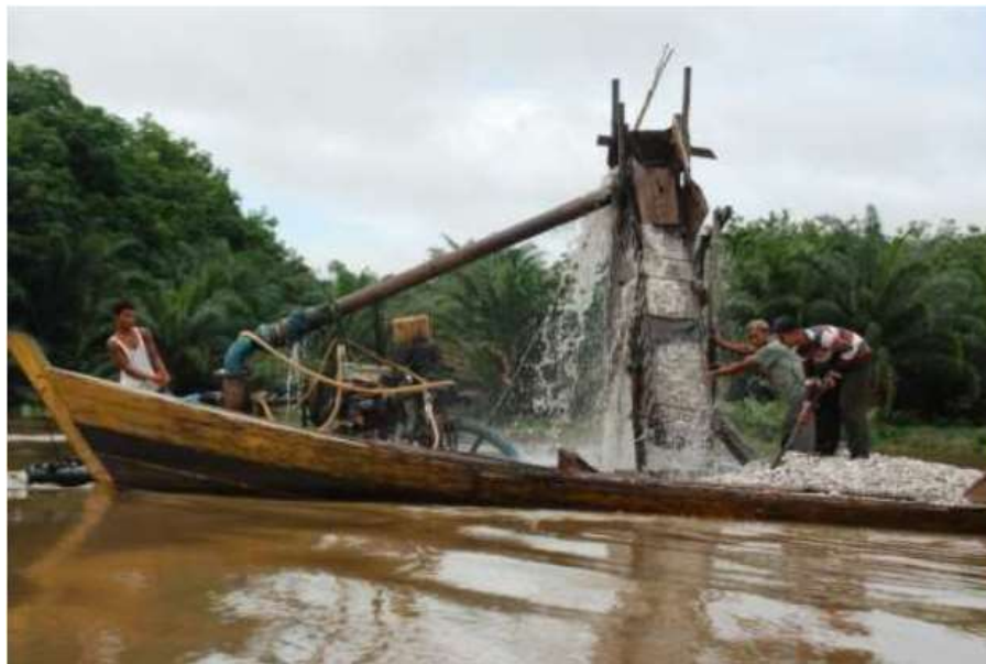
Pengambilan pasir dan kerikil di Sungai Kampar Kanan meningkatkan kekeruhan air dan sedimen (dokumen Aryani, 2014)
