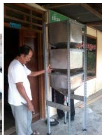
memungkinkan proses produksi bekerja secara otomatis dengan setting waktu proses secara digital, sehingga diharapkan proses produksi lebih efektif dan efisien serta hemat dalam penggunaan daya listrik.
