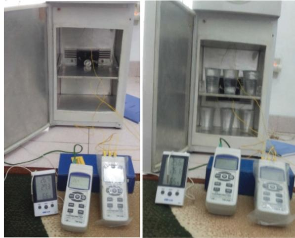
Gambar 3. Foto pengujian *box cooler*, tanpa beban (a), dengan beban pendingin (b)
