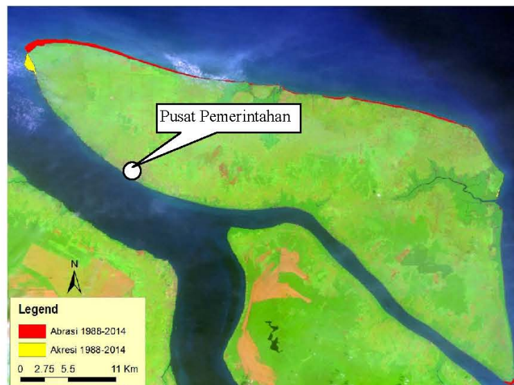
Gambar 4. Pantai Pulau Bengkalis yang mengalami abrasi dan akresi pada kurun waktu tahun 1988 - 2014
