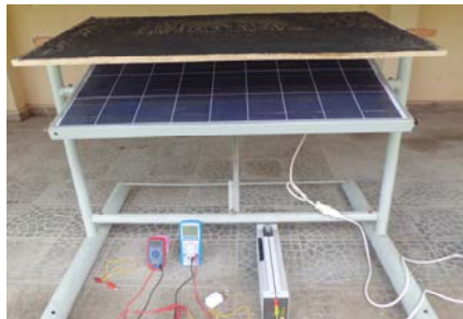
Gambar 4. Set up percobaan untuk mengukur kurva I(V) modul fotovoltaik silikon polikristal Hooray MCP-2 dengan pemasangan screen pada permukaan modul
