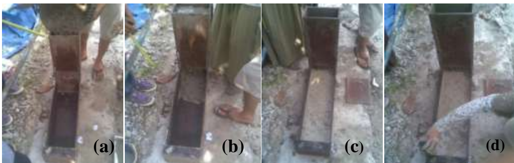
Gambar 5. Pengujian passingability , (a) menuang SCC ke dalam L-Box, (b) SCC mulai mengalir, (c) SCC berhenti mengalir, (d) mengukur H2
