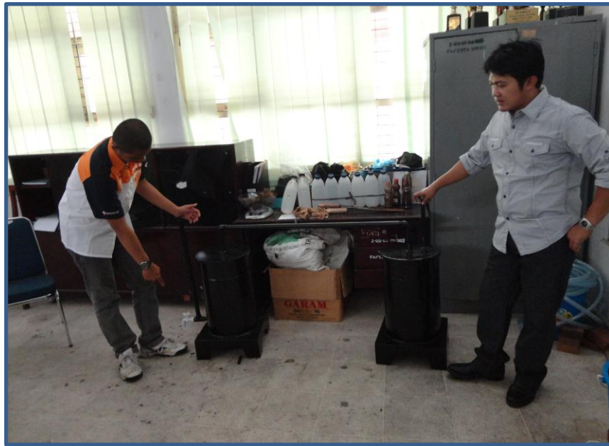
Gambar 2. Alat Pirolisis Sederhana
