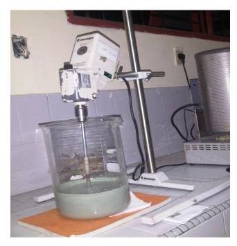
Gambar 3.2 Proses impregnasi logam ke zeolit aktif
