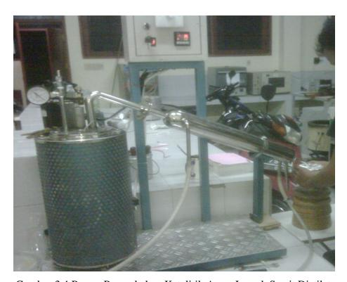
Gambar 3.4 Proses Perengkahan Katalitik Asam Lemak Sawit Distilat
