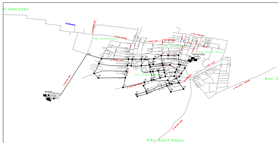
Gambar 7 Jaringan Pipa Distribusi Air Skenario 1 Tahap 2
