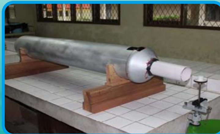
Gambar 5.2. Kanal udara dengan variasi kecepatan aliran
