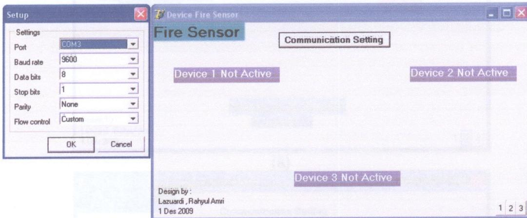
Gambar 25 Tampilan sensor kebakaran hutan dalam kondisi initial. Setting pengunduhan data diperlihatkan pada kotak ikon di sebelah kiri, Ketiga sensor dalam keadaan tidak aktif.
