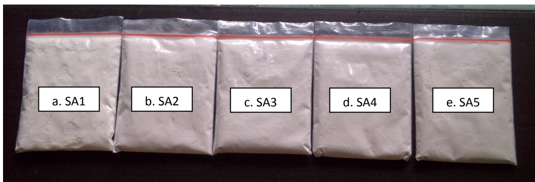
Gambar 1. a. SA1 (Pati sagu alami); b. SA2 (Pati sagu terasetilasi selama 30 menit); c. SA3 (Pati sagu terasetilasi selama 60 menit); d. SA4 (Pati sagu terasetilasi selama 90 menit); e. SA5 (Pati sagu terasetilasi selama 120 menit)
