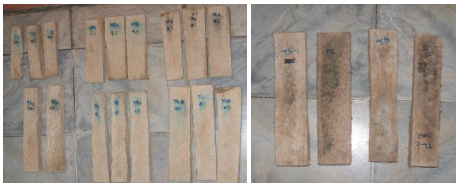
Gambar 8. Hasil Penelitian Papan Sawit yang Diawetkan (kiri), dan yang tidak diawetkan (kanan)
