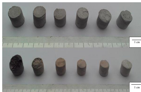
Gambar 1. (a) green bodies yang terbentuk sebelum proses sintering ; (b) sintered bodies yang terbentuk setelah proses sintering
