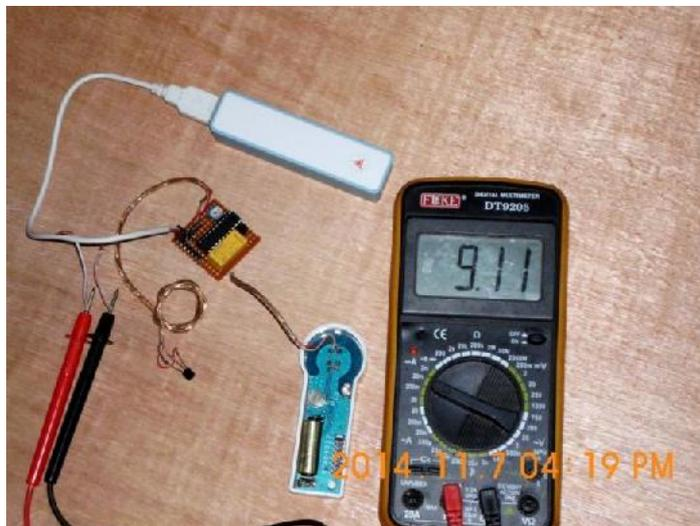
**Gambar 4.19** multimeter pada sistem dengan selector pada pengukuran arus mA
