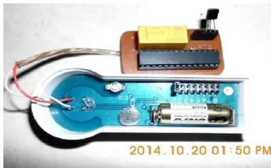
Gambar 4.16 Modul rangkaian mikrokontroller dihubungkan dengan modul rangkaian transmitter
