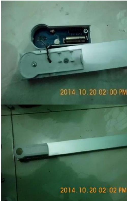
**Gambar 4.17** Rangkaian prototype alat yang berisi transmitter, sensor dan battery
