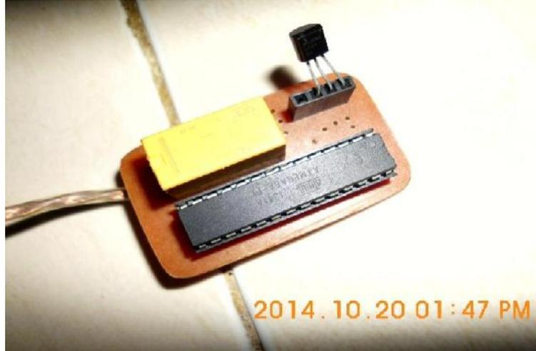
Gambar 4.15 Modul rangkaian mikrokontroller dan sensor
