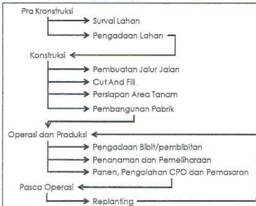
**Gambar 3. LCA Seluruh Proses Industri Kelapa Sawit**
