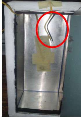
Gambar 3.16 Termokopel pada box aluminium
