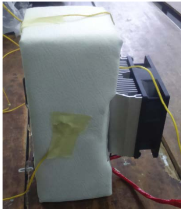
Gambar 3.14 Termokopel pada dinding luar
