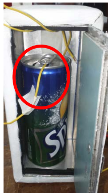
Gambar 3.19 Termokopel pada air minuman kaleng
