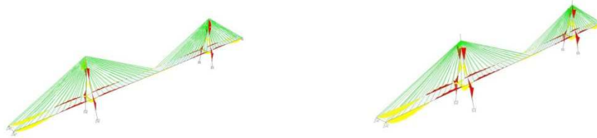
Gambar 5. Diagram Momen Struktur Jembatan Akibat Berat Sendiri (kiri: fan , kanan: radial )
