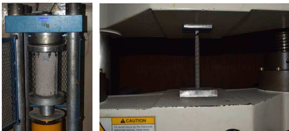
(a) Uji tekan beton
