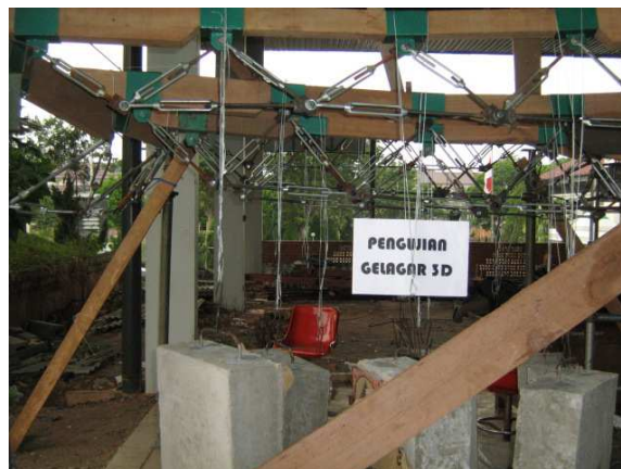
Gambar 6. Uji Pembebanan Gelagar Multikonektor Skala Penuh
