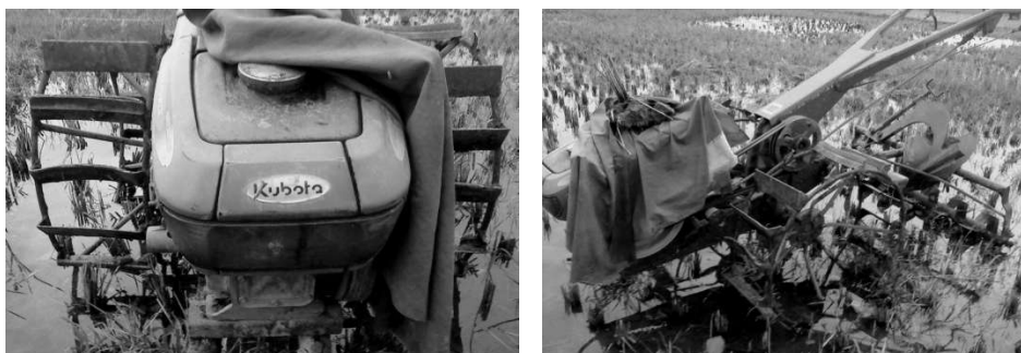
(a)Tangki bahan bakar dan engine (b) traktor dan bajak singkal Gambar 7. Traktor Tangan Kubota dengan Implemen Bajak Singkal
