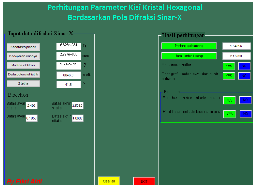
Gambar 2 Tampilan program menu perhitungan parameter kisi kristal cobalt berstruktur hexagonal
