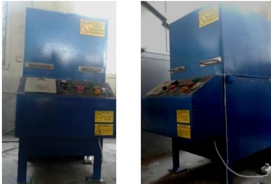
**Gambar 4.** Mesin *centrifugal casting* hasil rancangan.
