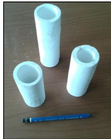
**Gambar 7.** Hasil pengecoran yang sudah dibakar pada 1350°C
