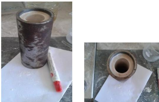
**Gambar 5.** Hasil pengecoran yang masih dalam cetakan.
