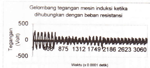
Gambar 8. Respon tegangan mesin induksi ketika dihubungkan dengan beban resistive 110 ohm.
