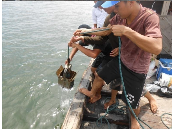
Grab Sampler saat diturunkan dari boat penelitian untuk mengambil sedimen permukaan
