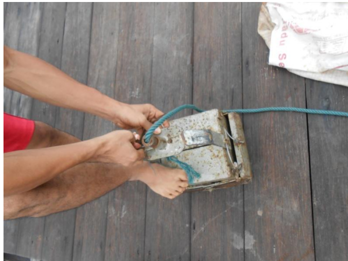
Botol van dorn sampler diturunkan secara vertikal dari atas kapal untuk mengambil sampel TSS
