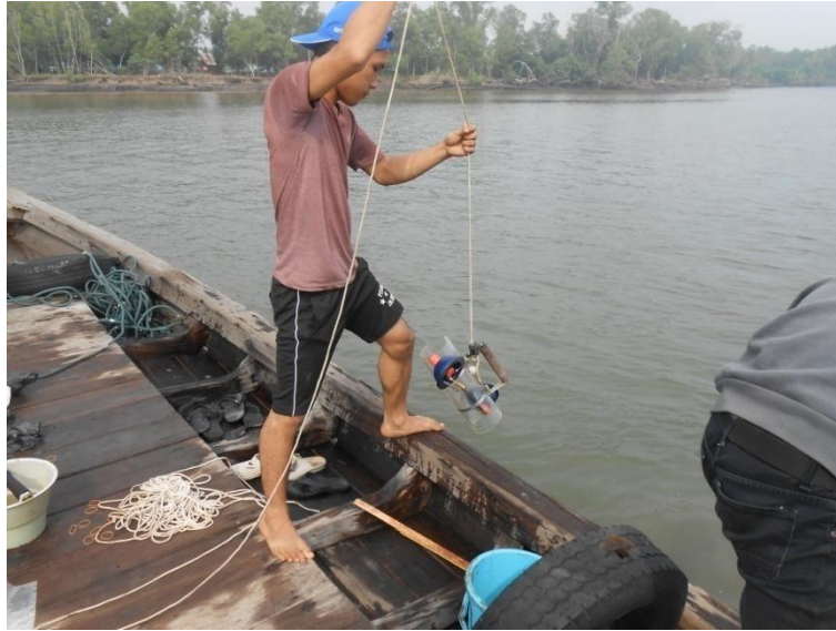
Botol van dorn sampler diturunkan secara vertikal dari atas kapal untuk mengambil sampel TSS
