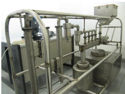
Gambar 5. Foto reaktor fast pyrolysis skala lab, unit pendukungnya termasuk sistem data akuisisi menggunakan perangkat agilent data acquisition 34970a
