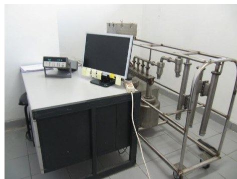
Gambar 5. Foto reaktor fast pyrolysis skala lab, unit pendukungnya termasuk sistem data akuisisi menggunakan perangkat agilent data acquisition 34970a
