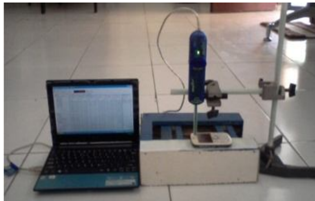
Gambar 1. Desain eksperimen untuk menentukan induksi magnetik statik dari telepon seluler.
