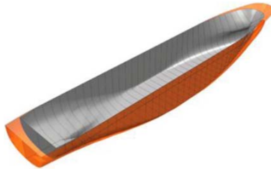
Gambar 4. Penambahan Extra Lenght pada ukuran Utama kapal
