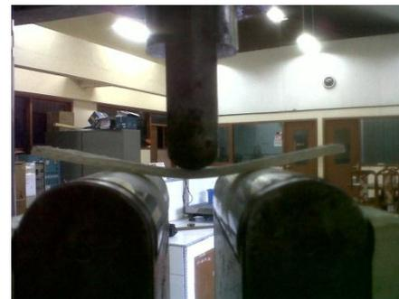
Gambar 4.10 Proses Pengujian Bending
