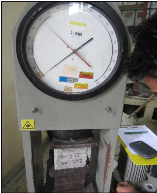
Gambar 2. Pengujian kuat tekan beton
