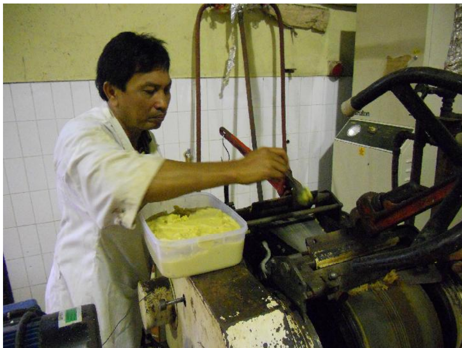
Gambar Pelaksanaan Pengeringan Produk bubuk formulasi instan yang difortifikasi dengan Konsentrat Protein Ikan Patin menggunakan alat drum drier
