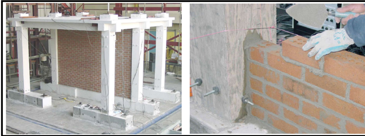
Gambar 2.2. Setting up pengujian portal dengan dinding pengisi (Hashemi, dkk 2007)
