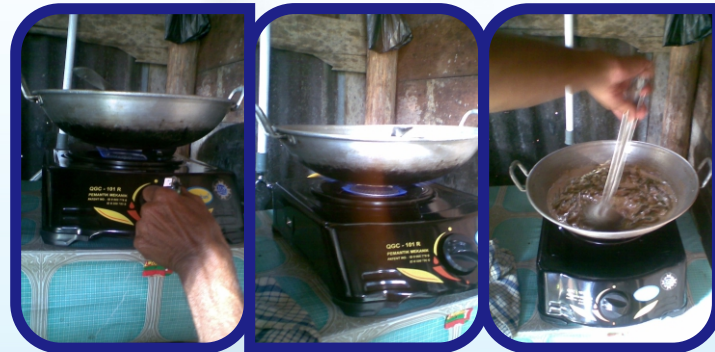
Gambar Pengujian Biogas Pada Kompor Yang Dimodifikasi Untuk Memasak Sayuran
