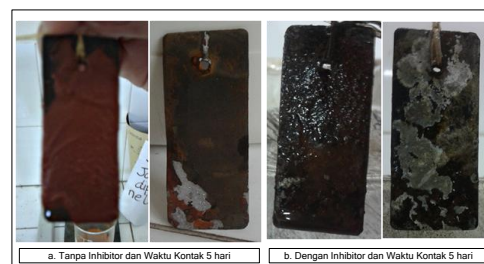
Gambar 6. Besi (a) Tanpa dan (b) Dengan Penambahan Inhibitor Setelah Perendaman 5 hari dan Setelah Dibersihkan
