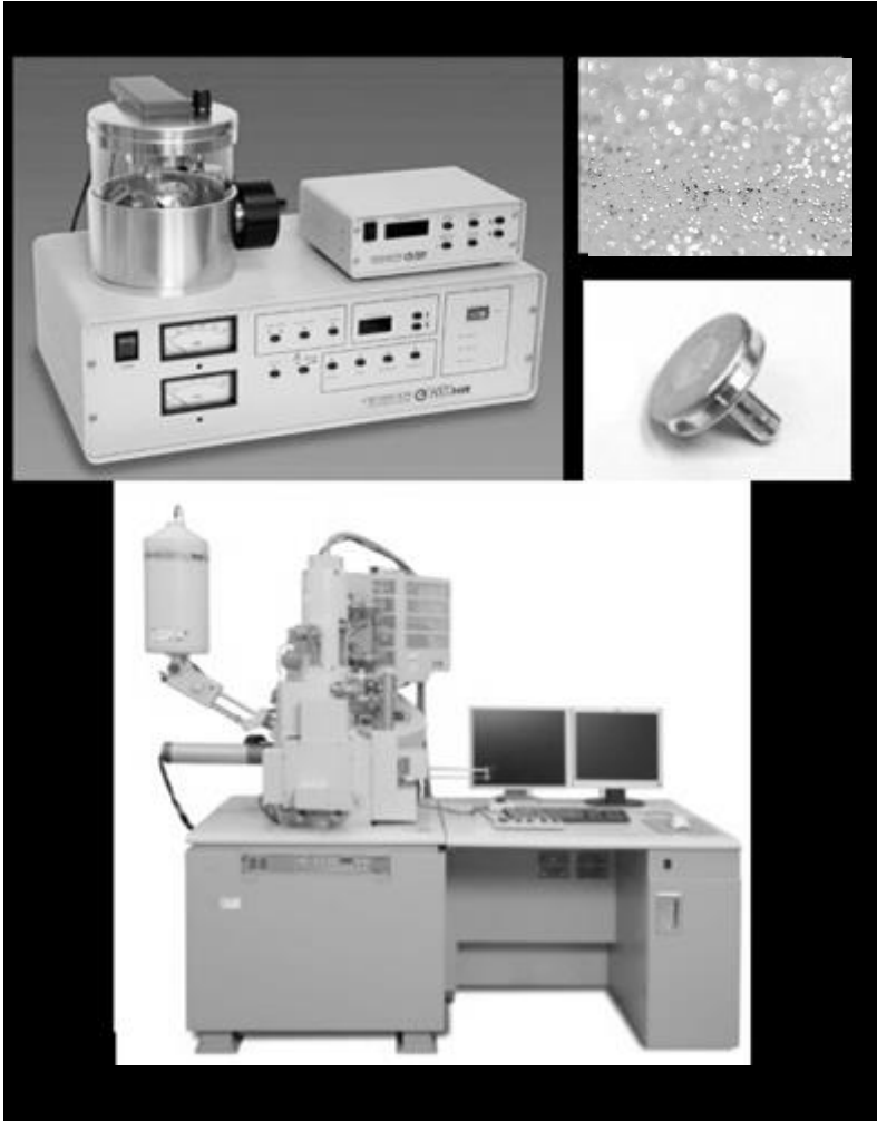
Gambar 3.3. alat dan bahan persiapan preparat spora tanpa aseptolisis untuk SEM (atas searah jarum jam : Sputter coated, serbuk emas, sample holder. Bawah : SEM) (Gambar dari berbagai sumber).
