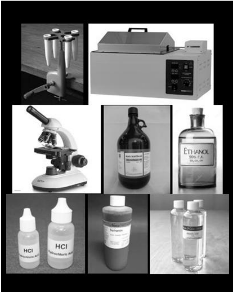
Gambar 3.5. Alat dan bahan yang digunakan dalam metode Asetolisis untuk pengamatan menggunakan mikroskop cahaya (dari kiri ke kanan mulai dari atas : hand centrifuge, water bath, mikroskop cahaya, AAG, HCL , etanol, safranin, gliserin) (Gambar dari berbagai sumber).
