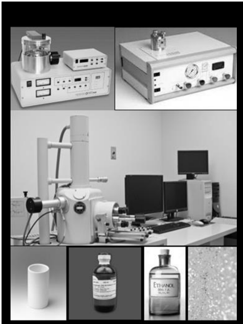
Gambar 3.8. Alat dan bahan untuk pegamatn spora menggunakan Metode asetolisis untuk pengamatan Scanning Electron Microscope (SEM). (Atas dari kiri ke kanan : Sputter coated, CPD. Tengah : SEM. Bawah dari kiri ke kanan : porous pot, glutaraldehid, etanol, serbuk emas) (Gambar dari berbagai sumber)
