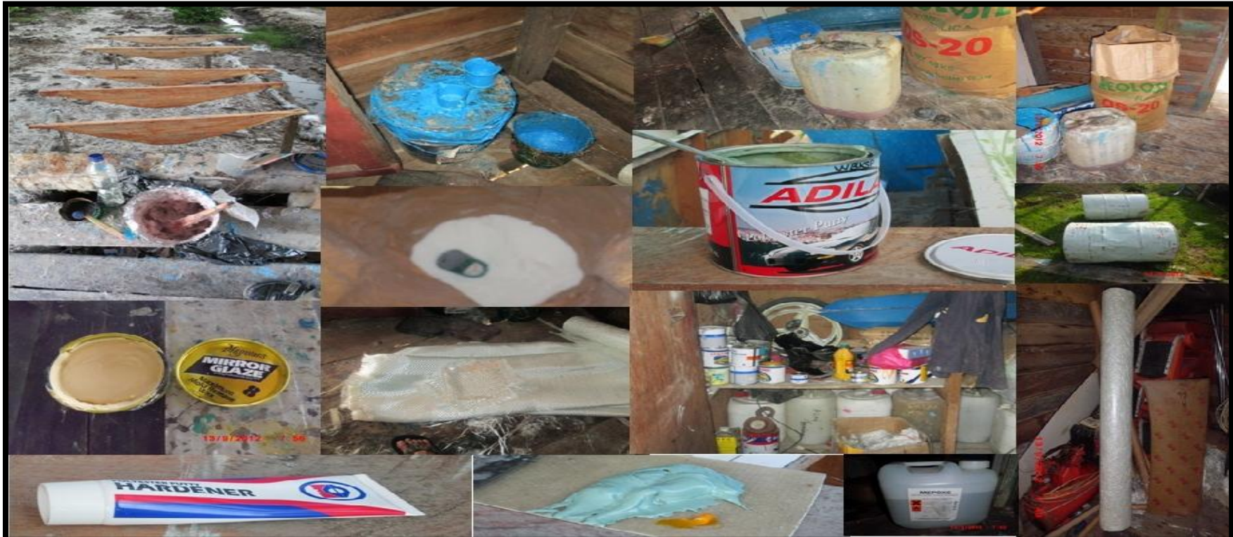
Gambar 5. Bahan-bahan yang dipergunakan dalam pembuatan kapal FRP
