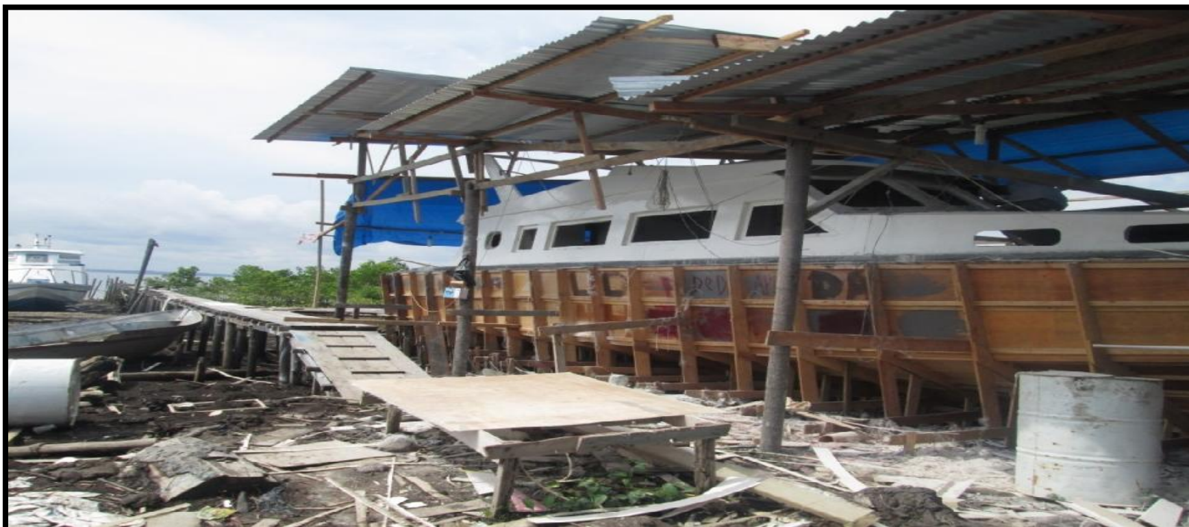
Gambar 3. Gambaran induk cetakan tubuh kapal FRP yang dibangun pada galangan kapal Bengkalis Marine Fiber.
