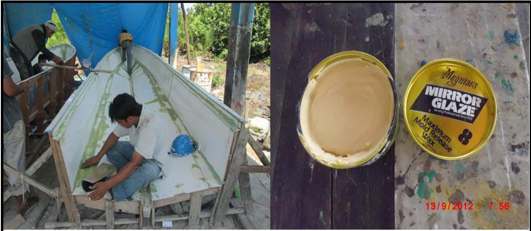
Gambar 7. Cetakan kapal diolesi mirror glass (kanan).
