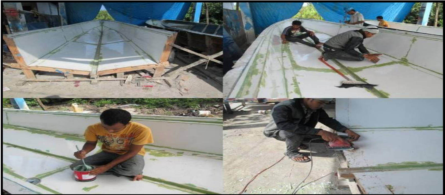
Gambar 6. Menyiapkan cetakan kapal.
