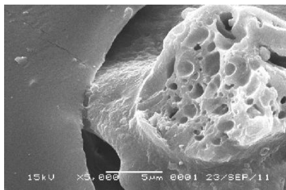
Gambar E.47: Micrograph SEM TR dengan Kadar Silika 30 phr
