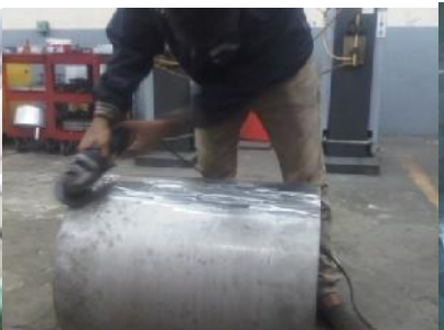
Proses Finishing (dengan gerinda)
