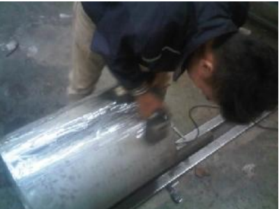
Proses Finishing (dengan gerinda)
