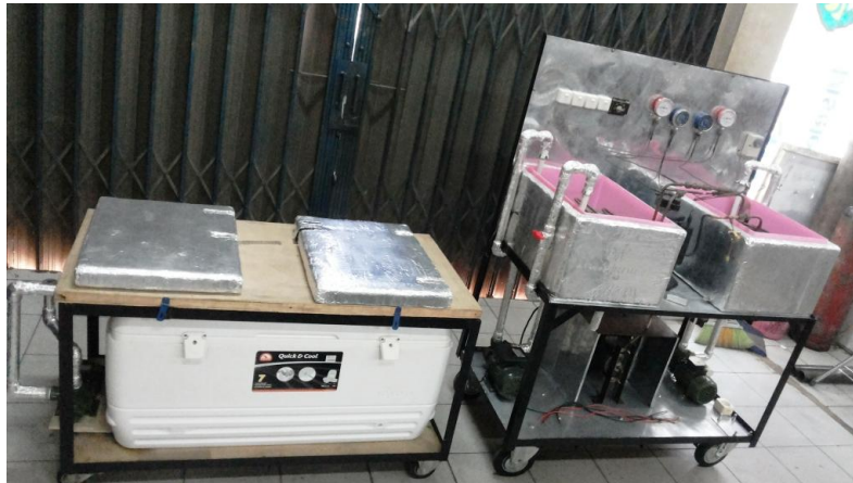
Gambar 11. Sistem refrigerasi hibrida dengan thermal storage
