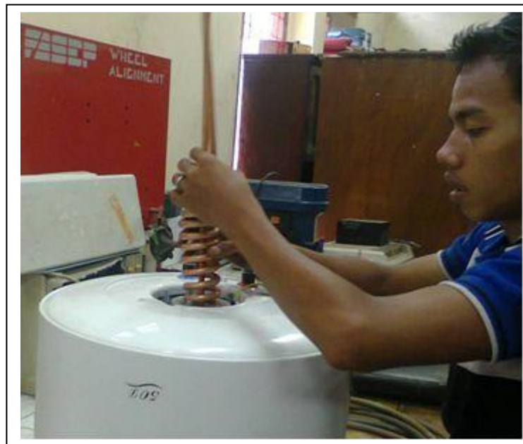
Gambar L2.4. Kondensor dummy berdasarkan hasil rancangan yang akan dipasang dalam tangki air panas
