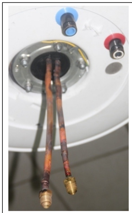
Gambar L2.7. Kondensor dummy dengan tutup tangki dan magnesium anoda untuk mencegah perkaratan di dalam air
