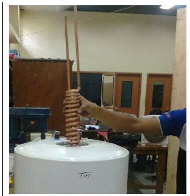
Gambar L2.6. Kondensor dummy dan tangki air panas tampak samping
