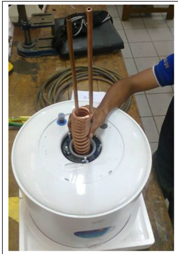
Gambar L2.5. Kondensor dummy dan tangki air panas tampak atas
