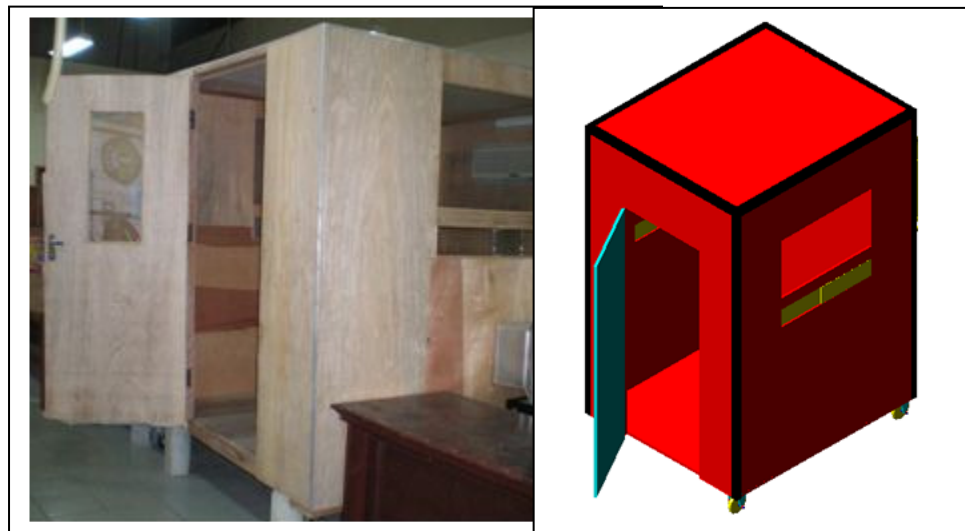
Gambar 5.4. Realisasi ruang uji mesin refrigerasi hibrida dari hasil rancangan
