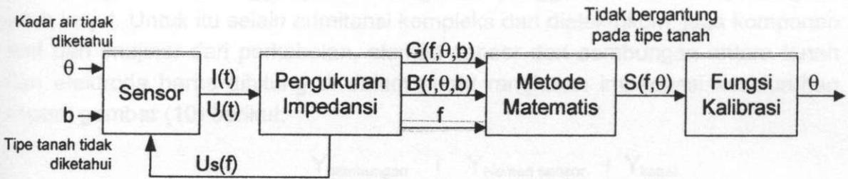
Gambar 8. Struktur percobaan spektrometer
