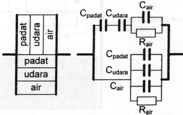
Gambar 9. Lapisan dielektrikum (kiri) dengan gambar rangkaian pengganti
