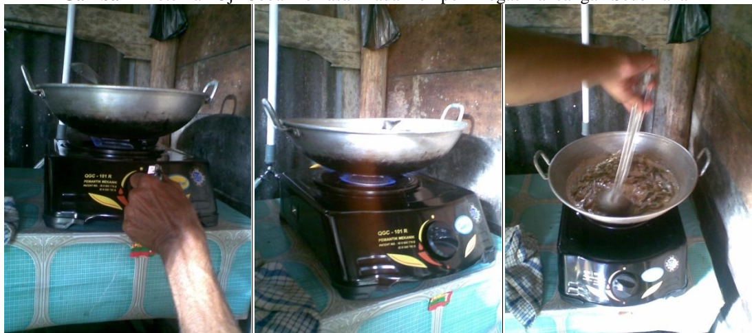
Gambar 8 Pengujian Biogas Pada Kompor Yang Dimodifikasi Untuk Memasak Sayuran
