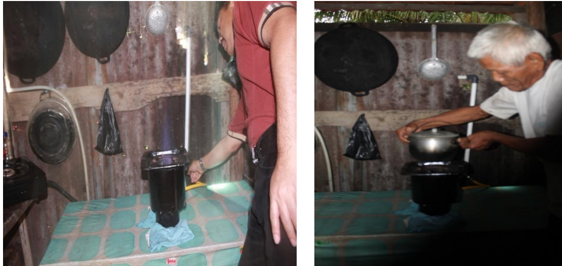
Gambar 7 Peternak Uji-Coba Memasak Pada Kompor Biogas Rancangan Sederhana
