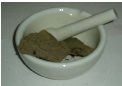
Pengerjaan sampel sediment untuk analisis logam berat
