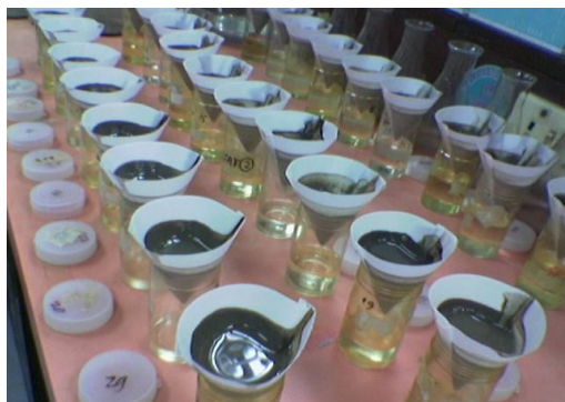
Pengerjaan sampel sediment untuk analisis logam berat
