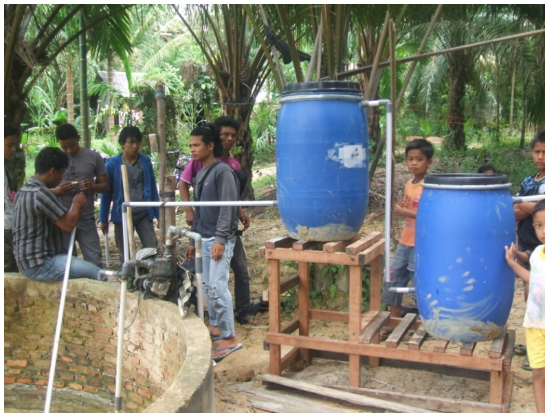
Gambar 3. Rangkaian alat penyaringan pasir yang sudah siap digunakan
