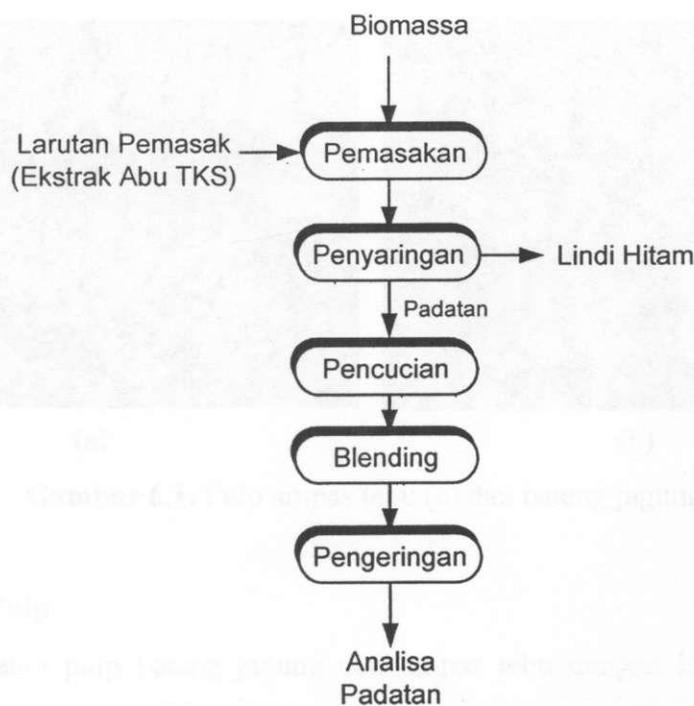
**Gambar 5.1.** Skema Percobaan Pembuatan Pulp
