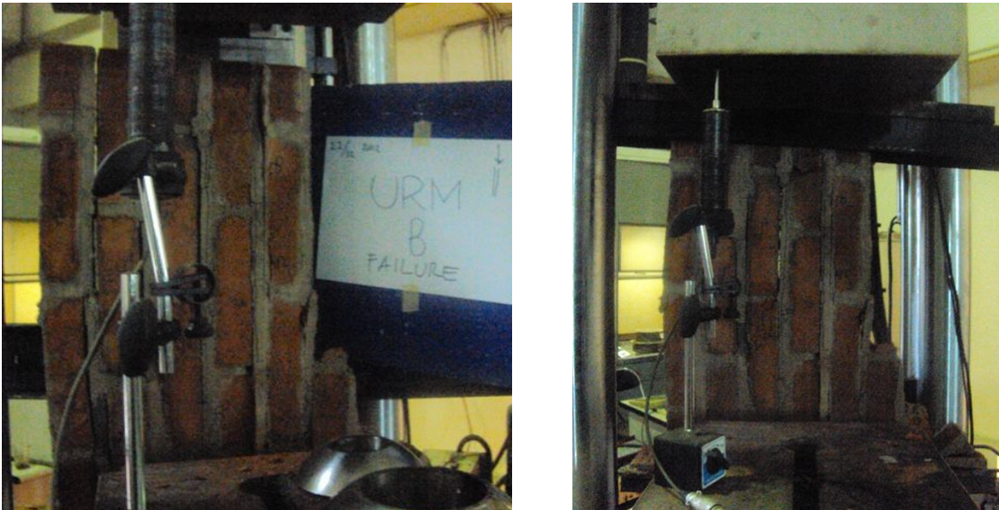
Gambar 5.12. Pola retak dan keruntuhan benda uji URM-B
