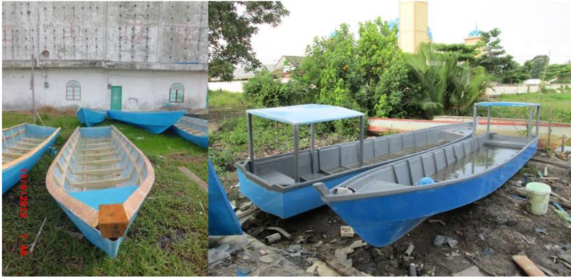
Gambar 13. Konstruksi kapal FRP berukuran 1.5-2 GT yang sedang dibangun di galangan kapal Karya Sakti dan Bengkalis Marine Fiber.
