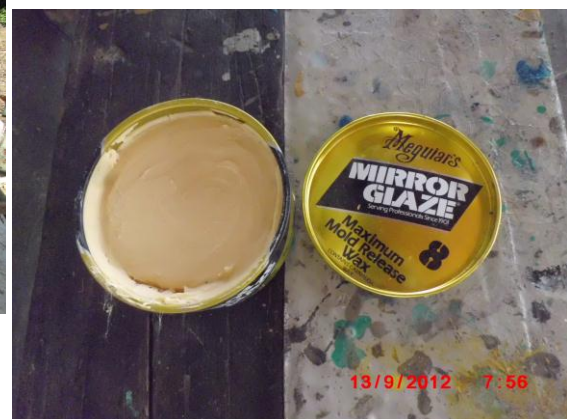
Gambar 19. Cetakan kapal diolesi mirror glass agar lapisan fiber glass tidak melekat pada cetakan.
