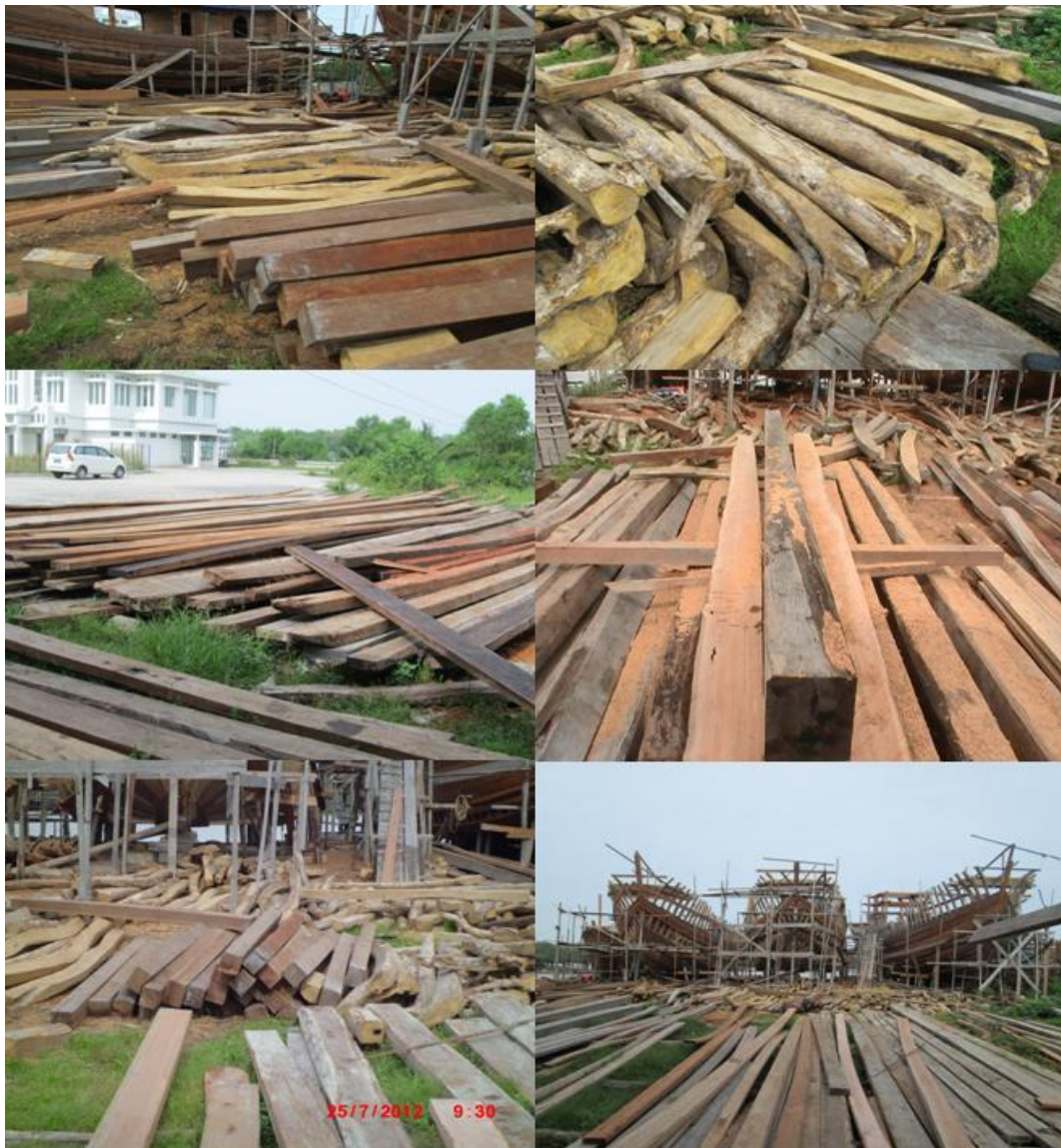
Gambar 10. Bahan baku kayu untuk kapal ukuran 100-350 GT di galangan kapal kayu skala besar di Bagan Siapi-api.
