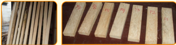
Gambar 1. Hasil Pengolahan Batang Sawit menjadi Papan Lembaran
